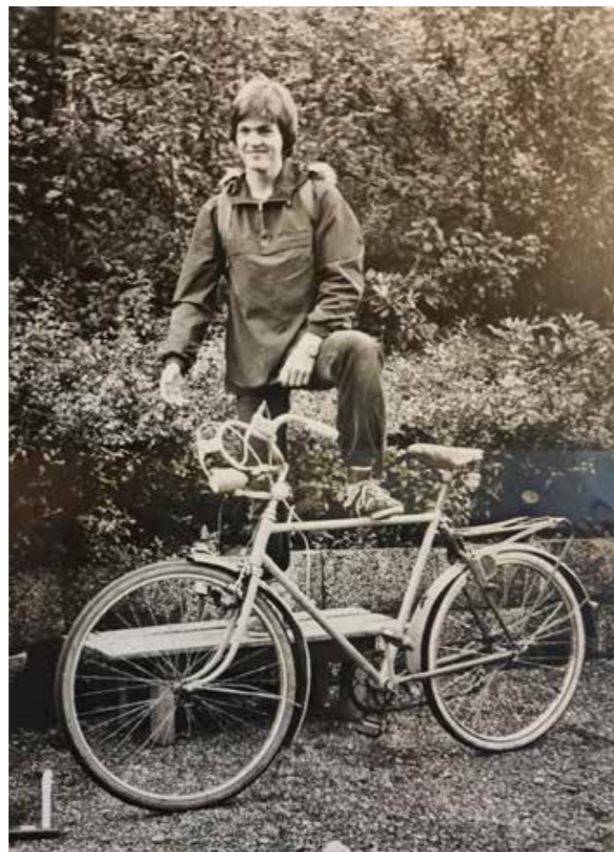
Knut 1979, veldig stolt. Han hadde spilt et racernavn med kassett og ekstern gir inn i vanlig 26 toms felg. Dermed ble det faktisk verdens første offroadsykel.
